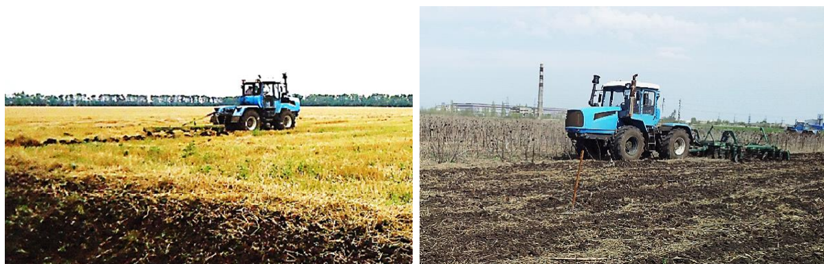
Рисунок 1 – Трактор ХТЗ-21021 с бесступенчатой ГОМТ-1С а) вспашка 24.07.2015 на испытаниях в «Элитном» и б) дискование 29.04.2015 в ООО «Агрофирма Репина», Харьковская область, Украина
