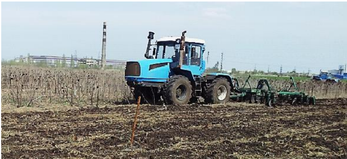
Рисунок 4 – Трактор ХТЗ-21021 з ГОМТ-1С на польових випробуваннях (дискуванні) 29.04.2015 в Харківський обл.
