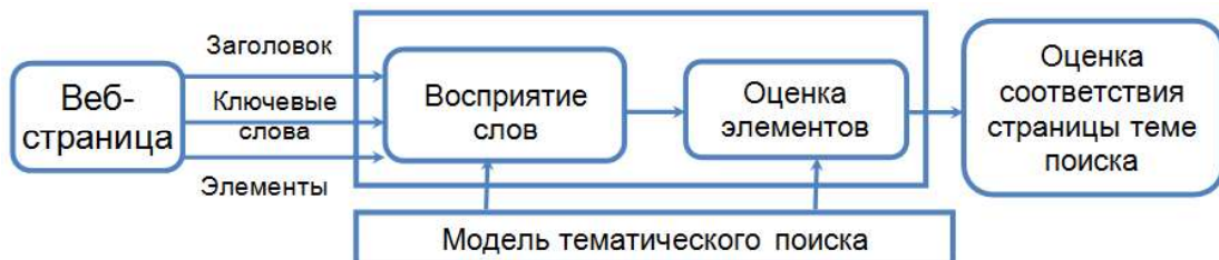
Рисунок 5 – Компаратор для поиска источников данных бизнес-информации
