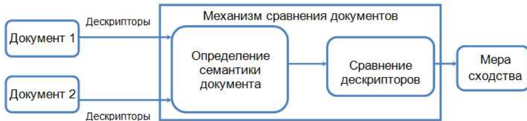
Рисунок 7 – Компаратор для нахождения меры сходства веб-источников Источник: авторская разработка
