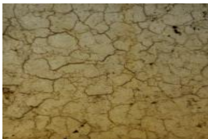
Рисунок 2 – Характерный рисунок поверхностных трещин после обработки образца раствором танина
